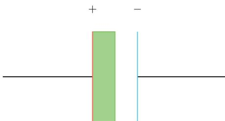
Wenn das Dielektrikum parallel zur Platte ist wird die elektrische Flussdichte nicht beeinflusst. Da für das elektrische Feld  $E$  die Distanz  $d$  nicht mehr konstant ist, gelten die folgenden Formel.
