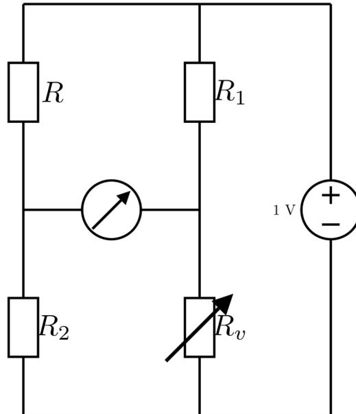
Um den Widerstand zu bestimmen verändert man den variablen Widerstand, bis der Voltmeter eine Spannung von 0V anzeigt. Mit der Gleichung lässt sich denn der Widerstand messen.
