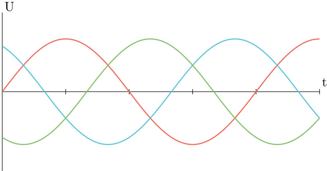
Diese kann generiert werden indem drei Leiterschleifen, welche 120° räumlich verschoben sind rotiert werden.
