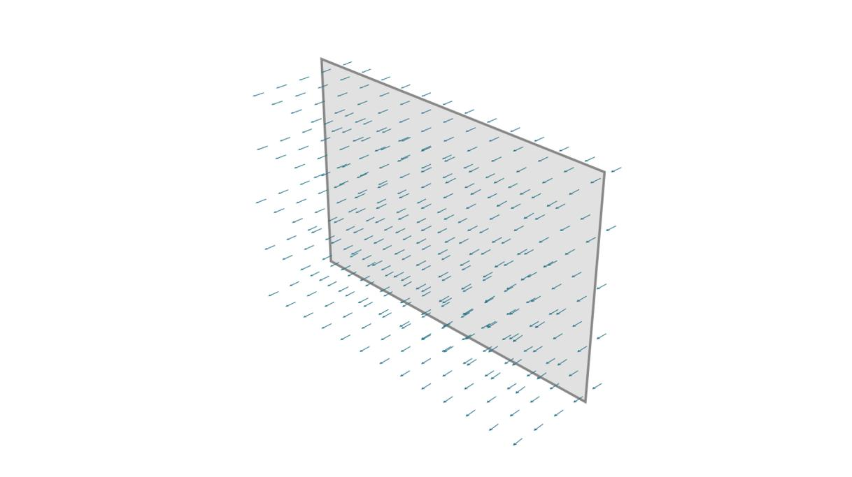
Da es keine magnetische Einzelladungen gibt, kann nirgendwo ein B-Feld entspringen oder verschwinden. Ähnlich wie bei der Stromdichte bedeutet dies, dass alles, was in eine Fläche hinein fließt, auch wieder herausfließen muss. [Miller, 2024]
