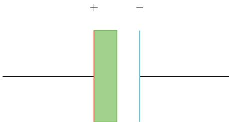
Wenn das Dielektrikum parallel zur Platte ist wird die elektrische Flussdichte nicht beeinflusst. Da für das elektrische Feld  $E$  die Distanz  $d$  nicht mehr konstant ist, gelten die folgenden Formel.
