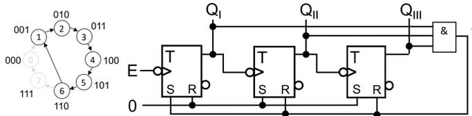
Der Zustand  $n + 1$  ist kurzzeitig für die Durchlaufzeit des AND-Gatters vorhanden an den Ausgängen, bis der Rücksprung zum Anfangszustand durchgeführt wurde.
