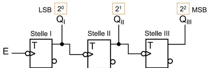
Will man einen Rückwärtszähler realisieren, dann muss man auf die positive Flanke gesteuerte FFs verwenden ( $0 \rightarrow 1$ ) und statt  $Q_i$  die invertierten Ausgänge  $\overline{Q}_i$  benutzen.
