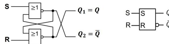
$$Q_{n+1} = S \vee (Q_n \wedge \bar{R}) \quad \text{Bedingung: } R \wedge S = 0$$
