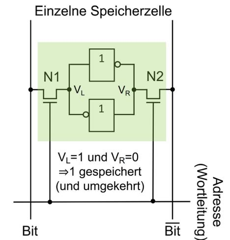
An  $V_L$  liegt der gespeicherte Wert der Speicherzelle und an  $V_R$  der invertierte Wert.
