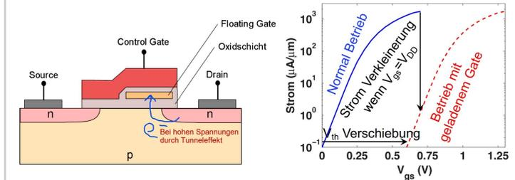
Nach etwa 20 minütiger Bestrahlung durch UV-Licht sind die negativen Ladungen wieder aus dem Floating-Gate entfernt und der Transistor zeigt erneut normales Verhalten.
