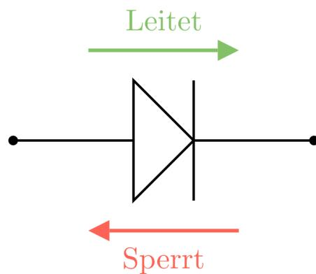
Für die Analyse der Diode ist Diodenkennlinie von grosser Bedeutung. Neben der maximalen Durchlassstrom zeigt die Diodenkennlinie auch die Durchbruchsspannung. Überschreitet man den Durchlassstrom bzw. die Durchbruchsspannung, so geht die Diode kaputt.
