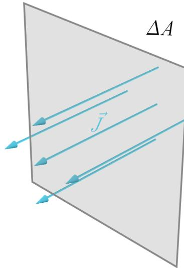
Die Stromdichte kann auch verwendet werden, um die Stromstärke zu berechnen.
