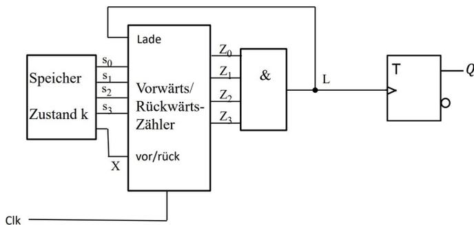
Mit einer solchen Schaltung kann man einen Frequenzteiler realisieren, welcher flexibler ist in seinem Teilungsverhältnis als ein simpler Frequenzteiler aus nur T-FFs.
