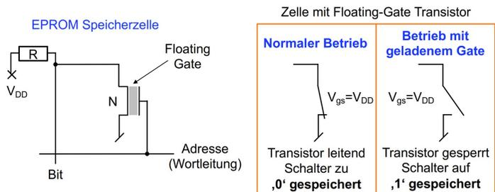
Floating-Gate Transistoren können negative Ladungen speichern, was die Kennlinie der für das Schalten notwendigen Gate-Source Spannung nach rechts verschiebt, als Folge reicht die  $V_{DD} \approx 0.8V$  Spannung nicht mehr aus für das Schalten des Transistors.
