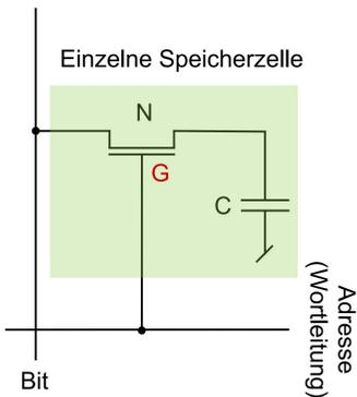
Der Kondensator agiert als Speicher. Beim Schreibvorgang wird die Bitleitung fest auf GND/VCC geschaltet und der Kondensator aufgeladen (1) bzw. entladen (0).
