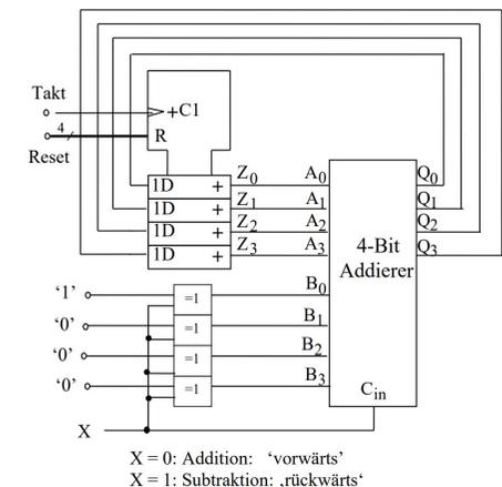
Für das Wechseln zwischen Vorwärts- und Rückwärtszählen wechselt man beim Addierer einfach zwischen Addition und Subtraktion (2er Komplement).
