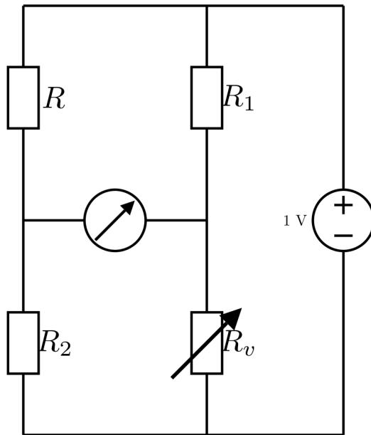
Um den Widerstand zu bestimmen verändert man den variablen Widerstand, bis der Voltmeter eine Spannung von 0V anzeigt. Mit der Gleichung lässt sich dann der Widerstand messen.
