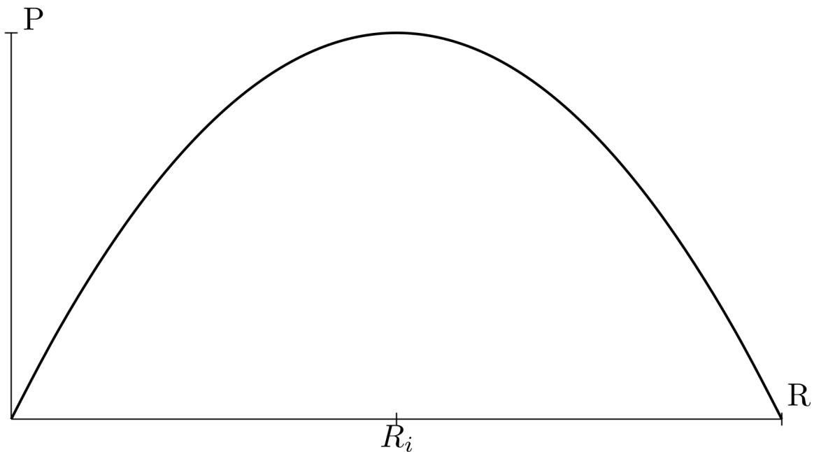
In den meisten Fällen ist  $R_L$  grösser als  $R_i$  da sonst die Hälfte der Leistung über  $R_i$  abgegeben wird und  $R_i$  in den meisten Fällen nicht dafür gebaut ist. Ausserdem besteht keine Gefahr für einen Kurzschluss.
