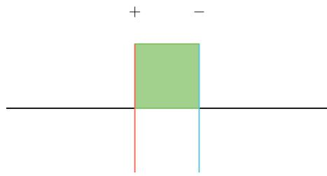
Wenn das Dielektrikum senkrecht zur Platte ist wird das elektrische Feld nicht beeinflusst. Da für den elektrischen Fluss  $D$  die Fläche  $A$  nicht mehr konstant ist, gelten die folgenden Formel.
