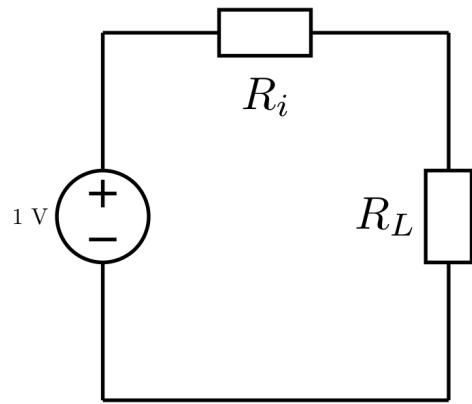
Ziel ist es  $R_L$  zu bestimmen, so dass die Leistung über  $R_L$  am grössten ist. Wie kann man nun  $R_L$  bestimmen? Wie ersparen uns die Rechnerei. (Siehe [Albach, 2020] S. 144) Aber damit eine Spannungsquelle die maximale Leistung ausgibt, muss  $R_L = R_i$  sein. Ist  $R_L$  zu gross, so fliesst kein Strom durch  $R_L$ . Ist  $R_L$  zu klein, so haben wir einen Kurzschluss. Daraus entsteht der folgende Graf.
