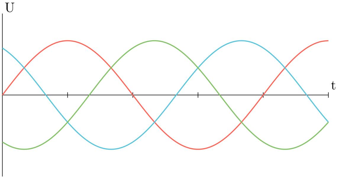
Diese kann generiert werden indem drei Leiterschleifen, welche  $120^\circ$  räumlich verschoben sind rotiert werden.
