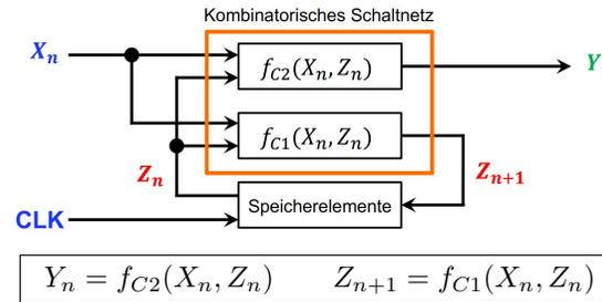
Erst bei einem Taktwechsel  $t_n \rightarrow t_{n+1}$  schalten die D-FF, d.h.  $Z_{n+1} \rightarrow Z_n$ .
