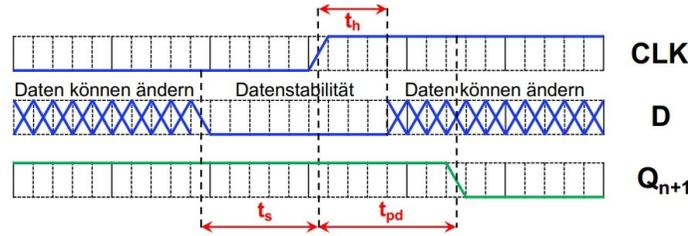
Setup-Zeit ( $t_s$ ) Solange muss Signal an FF vor aktiver Taktflanke stabil anliegen.
