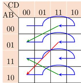
Bei 5 Schaltvariablen wird die 5te Schaltvariable mit einer ABCD Matrix für  $E$  und einer für  $\bar{E}$  dargestellt (2D!).
