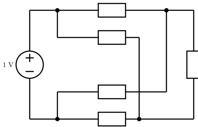
Um dieses Netzwerk zu analysieren verwendet man ein System, welches ein Gleichungssystem aufstellt um alle Größen berechnen zu können. In unserem Fall benötigen wir mindestens 6 Gleichungen, da wir 6 Zweige haben.
