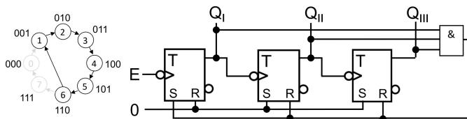
Der Zustand  $n + 1$  ist kurzzeitig für die Durchlaufzeit des AND-Gatters vorhanden an den Ausgängen, bis der Rücksprung zum Anfangszustand durchgeführt wurde.
