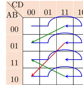
Bei 5 Schaltvariablen wird die 5te Schaltvariable mit einer ABCD Matrix für  $E$  und einer für  $\bar{E}$  dargestellt (2D!).
