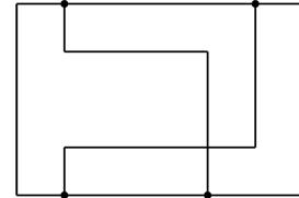
2. Definiere in jedem Zweig die Strom Richtung. Die Richtung kann willkürlich gewählt werden, da die Richtung durch ein Vorzeichen nach dem Auflösen vom Gleichungssystem korrigiert wird.
