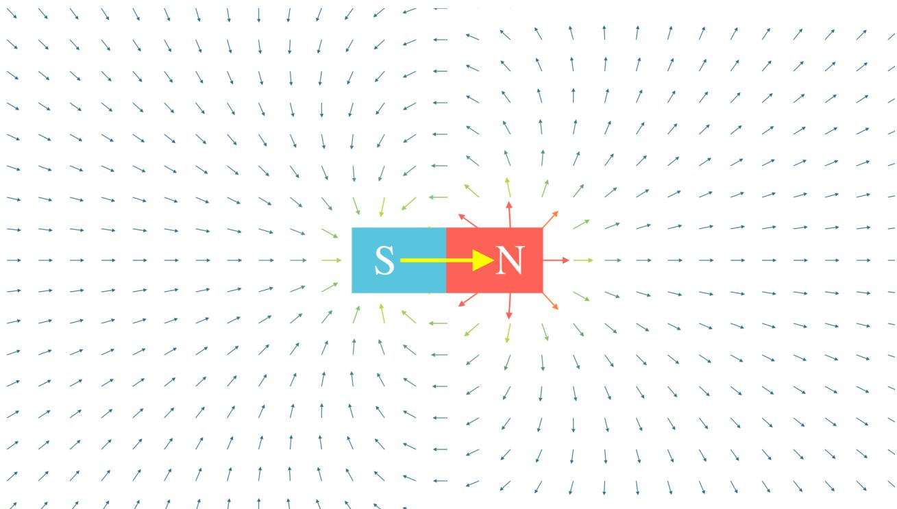
Anhand der Grafik kann man sehen, dass Magnete Kräfte ausüben. Man sieht, dass magnetische Feldlinien geschlossen sind und das Feld zeigt außerhalb des Magneten vom Nord- zum Südpol. [Miller, 2024] Innerhalb des Magneten verlaufen die magnetischen Feldlinien vom Süd- zum Nordpol.
