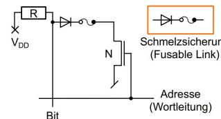
Die Programmierung erfolgt durch die Schmelzsicherung. Für eine '0' muss man nichts machen und für eine '1' wird die Schmelzsicherung durch eine hohe Spannung durchgebrannt.
