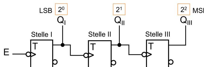
Will man einen Rückwärtzzähler realisieren, dann muss man auf die positive Flanke gesteuerte FFs verwenden ( $0 \rightarrow 1$ ) und statt  $Q_i$  die invertierten Ausgänge  $\bar{Q}_i$  benutzen.
