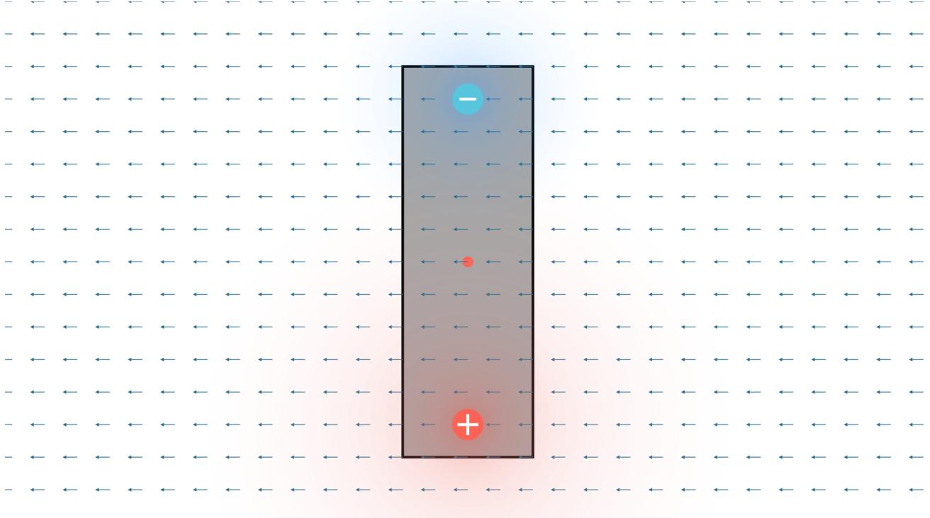
Das Metallstück kann nun als Spannungsquelle agieren. Wird es mit einem Widerstand verbunden, so fliesst ein Strom. Die Spannung der Spannungsquelle kann mit der folgenden Gleichung berechnet werden.
