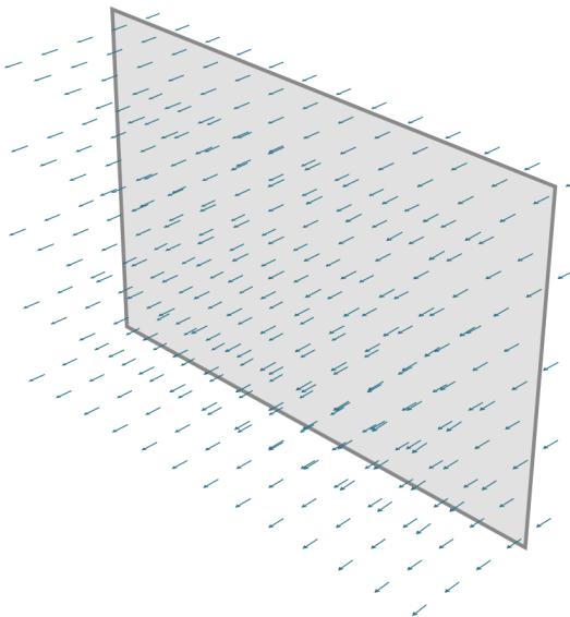
Da es keine magnetischen Einzelladungen gibt, kann nirgendwo ein B-Feld entspringen oder verschwinden. Ähnlich wie bei der Stromdichte bedeutet dies, dass alles, was in eine Fläche hinein fließt, auch wieder herausfließen muss. [Miller, 2024]
