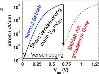
Nach etwa 20 minütiger Bestrahlung durch UV-Licht sind die negativen Ladungen wieder aus dem Floating-Gate entfernt und der Transistor zeigt erneut normales Verhalten.
