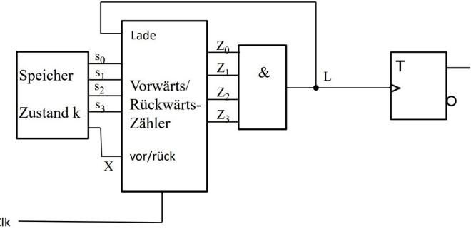
Mit einer solchen Schaltung kann man einen Frequenzteiler realisieren, welcher flexibler ist in seinem Teilungsverhältnis als ein simpler Frequenzteiler aus nur T-FFs.
