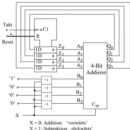
Für das Wechseln zwischen Vorwärts- und Rückwärtzzählen wechselt man beim Addierer einfach zwischen Addition und Subtraktion (2er Komplement).
