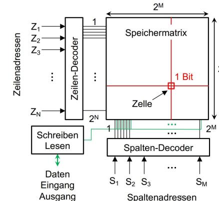
Dank den Decoden ist jede Speicherzelle einzeln ansprechbar mit nur linearem Wachstum in Adressleitungen bei höherer Zeilen-/Spaltenanzahl. Das Konstruktionsprinzip ist ein 'AND-Baum', wo jedes AND ein Minterm bildet. So besitzt jede Speicherzelle eine eindeutige Adresse.
