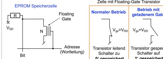
Floating-Gate Transistoren können negative Ladungen speichern, was die Kennline der für das Schalten notwendigen Gate-Source Spannung nach rechts verschiebt, als Folge reicht die  $V_{DD} \approx 0.8V$  Spannung nicht mehr aus für das Schalten des Transistors.
