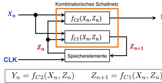
Erst bei einem Taktwechsel  $t_n \rightarrow t_{n+1}$  schalten die D-FF, d.h.  $Z_{n+1} \rightarrow Z_n$ .
