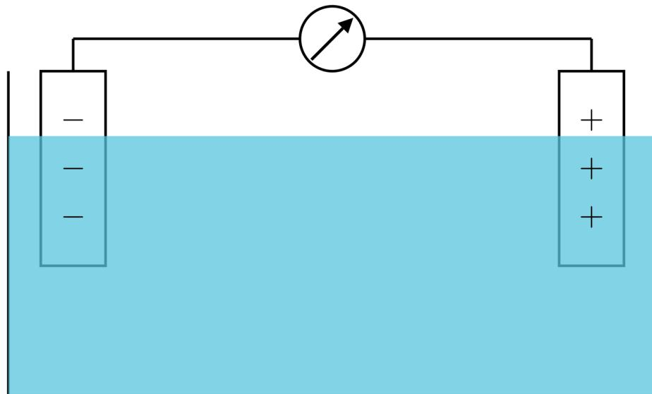
Sobald das Wasser verunreinigt wird so steigt der Stromfluss. Dies wird sehr deutlich wenn Salz zum Wasser beigefügt wird. Das Salz trennt sich im destillierten Wasser zu Natrium-Kationen (positive geladene Ionen) und Chlor-Anion (negative geladene Ionen). Die Kationen wandern zur Kathode während die Anionen zur Anode sich bewegen. Dort angekommen geben bzw. nehmen sie Elektronen auf. Dadurch fliesst ein Strom.
