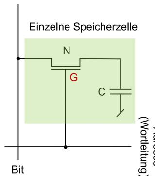
Der Kondensator agiert als Speicher. Beim Schreibvorgang wird die Bitleitung fest auf GND/VCC geschaltet und der Kondensator aufgeladen (1) bzw. entladen (0).
