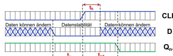
Setup-Zeit ( $t_s$ ) Solange muss Signal an FF vor aktiver Taktflanke stabil anliegen.
