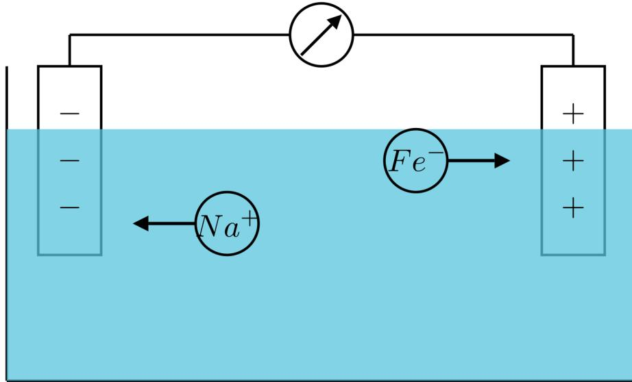
Dieser Prozess wird Elektrolyse genannt und wird sehr häufig fürs Galvanisieren verwendet.
