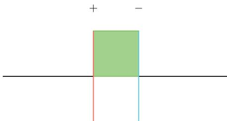
Wenn das Dielektrikum senkrecht zur Platte ist wird das elektrische Feld nicht beeinflusst. Da für den elektrischen Fluss  $D$  die Fläche  $A$  nicht mehr konstant ist, gelten die folgenden Formel.
