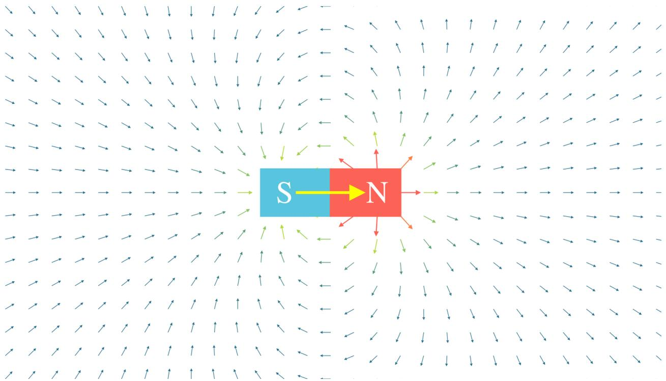
Anhand der Grafik kann man sehen, dass Magnete Kräfte ausüben. Man sieht, dass magnetische Feldlinien geschlossen sind und das Feld zeigt ausserhalb des Magneten vom Nord- zum Südpol. [Miller, 2024] Innerhalb des Magneten verlaufen die magnetische Feldlinien vom Süd- zum Nordpol.
