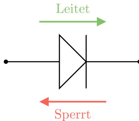
Für die Analyse der Diode ist Diodenkennlinie von grosser Bedeutung. Neben der maximalen Durchlassstrom zeigt die Diodenkennlinie auch die Durchbruchspannung. Überschreitet man den Durchlassstrom bzw. die Durchbruchspannung, so geht die Diode kaputt.
