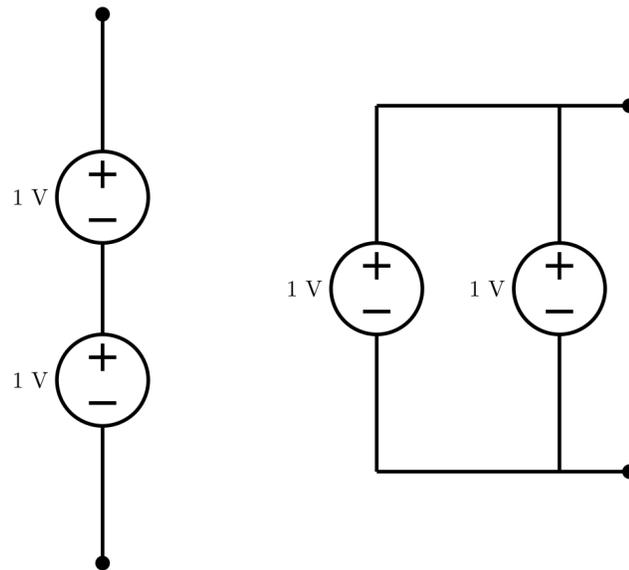
Spannungsquellen können in Serie oder Parallel geschaltet werden. Je nach dem haben sie eine andere Wirkung.
