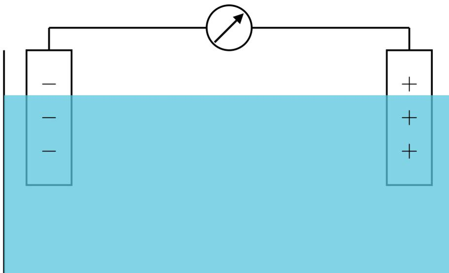
Sobald das Wasser verunreinigt wird so steigt der Stromfluss. Dies wird sehr deutlich wenn Salz zum Wasser beigefügt wird. Das Salz trennt sich im destillierten Wasser zu Natrium-Kationen (positive geladene Ionen) und Chlor-Anion (negative geladene Ionen). Die Kationen wandern zur Kathode während die Anionen zur Anode sich bewegen. Dort angekommen geben bzw. nehmen sie Elektronen auf. Dadurch fließt ein Strom.
