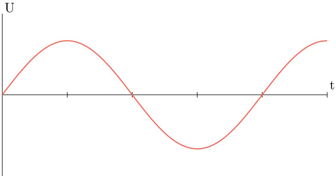
Wie man von der Abbildung sehen kann hat die Spannung eine sinusförmige Welle. Diese kann durch Induktion durch eine rotierende Leiterschleife in einem konstanten Magnetfeld erzeugt werden.
