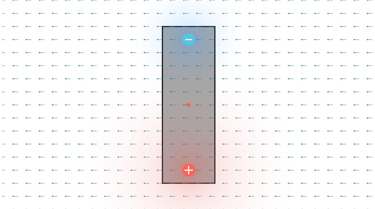
Das Metallstück kann nun als Spannungsquelle agieren. Wird es mit einem Widerstand verbunden, so fließt ein Strom. Die Spannung der Spannungsquelle kann mit der folgenden Gleichung berechnet werden.
