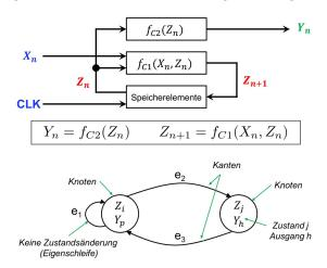
Eine komplett störungssichere Automatenfunktion ist jedoch nur möglich, wenn die Eingangswerte  $X_n$  mit gleich getakteten D-FF synchronisiert werden.
