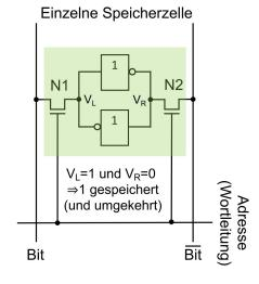
An  $V_L$  liegt der gespeicherte Wert der Speicherzelle und an  $V_R$  der invertierte Wert.
