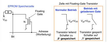
Floating-Gate Transistoren können negative Ladungen speichern, was die Kennline der für das Schalten notwendigen Gate-Source Spannung nach rechts verschiebt, als Folge reicht die  $V_{DD} \approx 0.8V$  Spannung nicht mehr aus für das Schalten des Transistors.
