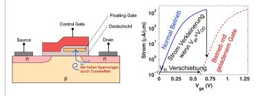
Nach etwa 20 minütiger Bestrahlung durch UV-Licht sind die negativen Ladungen wieder aus dem Floating-Gate entfernt und der Transistor zeigt erneut normales Verhalten.
