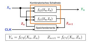
Erst bei einem Taktwechsel  $t_n \to t_{n+1}$  schalten die D-FF, d.h.  $Z_{n+1} \to Z_n$ .
