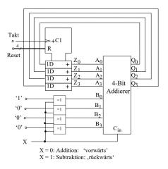
Für das Wechseln zwischen Vorwärts- und Rückwärtszählen wechselt man beim Addierer einfach zwischen Addition und Subtraktion (2er Komplement).
