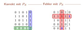
Für eine Fehlerkorrektur muss zusätzlich ein Prüfwort übertragen werden, welches Spaltenweise ein Parity-Bit bildet. Der Empfänger kann so das fehlerbehaftete Bit in der Matrixdarstellung (siehe Bsp.) erkennen und korrigieren.
