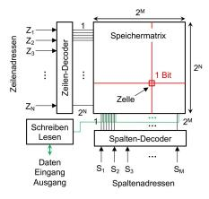
Dank den Decoder ist jede Speicherzelle einzeln ansprechbar mit nur linearem Wachstum in Adressleitungen bei höherer Zeilen-/Spaltenanzahl. Das Konstruktionsprinzip ist ein 'AND-Baum', wo jedes AND ein Minterm bildet. So besitzt jede Speicherzelle eine eindeutige Adresse.
