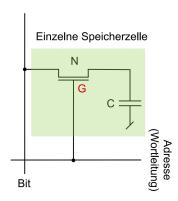
Der Kondensator agiert als Speicher. Beim Schreibevorgang wird die Bitleitung fest auf GND/VCC geschaltet und der Kondensator aufgeladen (1) bzw. entladen (0).
